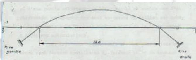
Le profil suivant l'axe de la chaussée comporte au milieu, un arc de parabole de 120 mètres de cordes, relié aux rives droite et gauche et dont le sommet est de 42,50 m.
